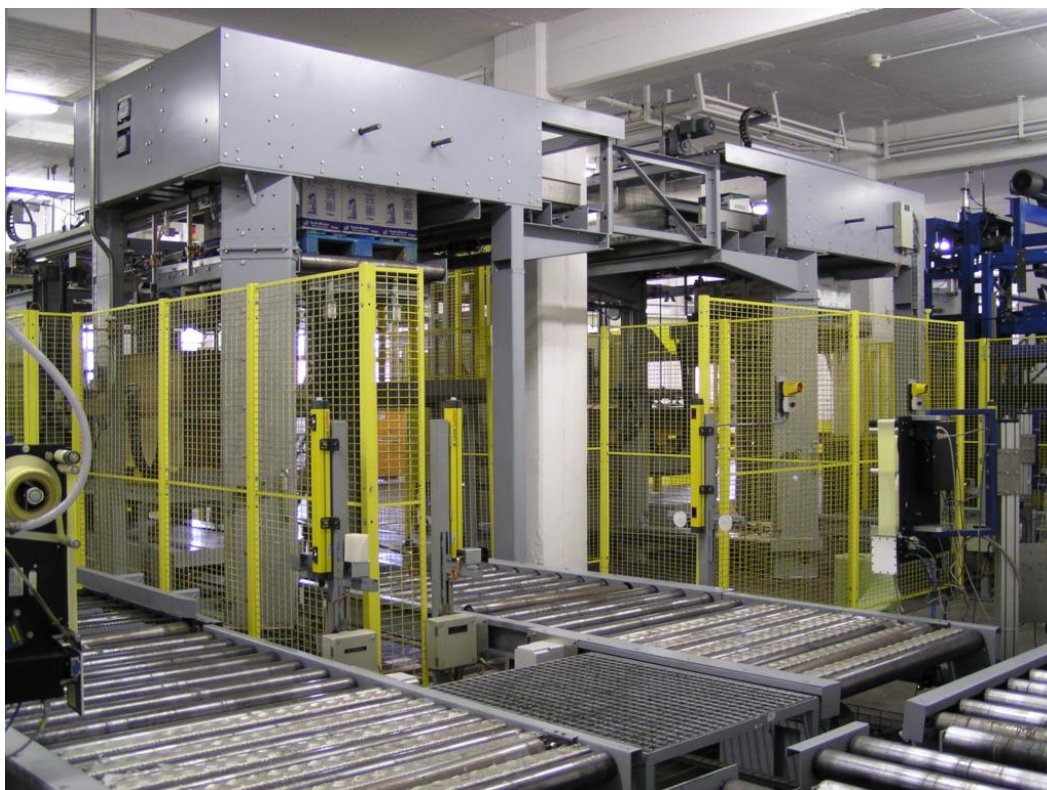
Два вида оборудования для паллетирования типа НРК
