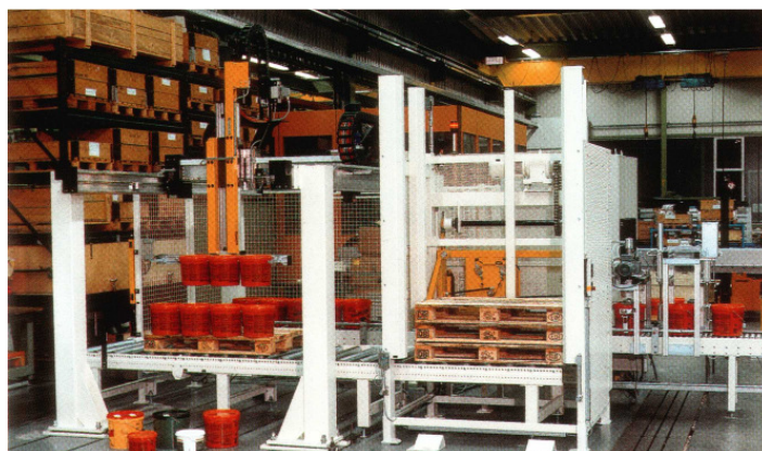
Robô pórtico para paletização de baldes
